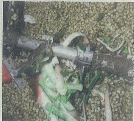
厨余分解机器利用颗粒状微生物，在24小时内分解厨余。
